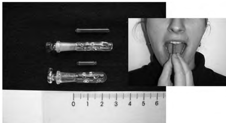
Afin d'empêcher le contact et donc une extraction directe de substances issues de la muqueuse buccale, il a été développé un système qui permet d'encapsuler le Twister : BOSS (à gauche) garanti dans la bouche un accès libre de la salive et de la phase gazeuse vers la couche de sorption du Twister et par conséquent, une extraction authentique des substances aromatisantes.
