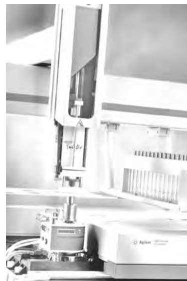
Système GC avec passeur automatique (MPS 2) et système de désorption thermique (TDU) pour l'analyse entièrement automatisée de jusqu'à 196 Twisters GERSTEL.
